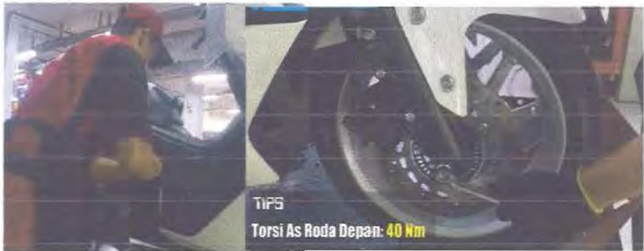
Gambar 3.21 pengecekan baut-baut pengikat
