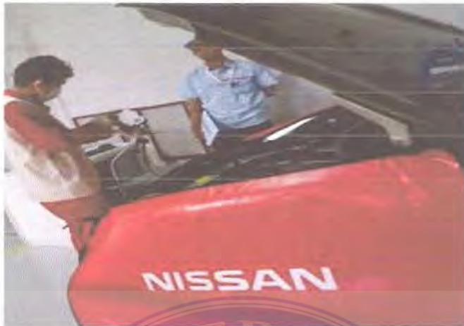
Gambar 3.13. Pemasangan Fender Cover.
