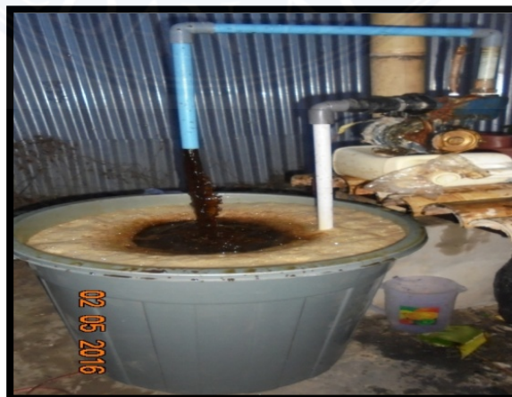
Gambar 10. Pengaktifan Limbah Cair Pabrik Kelapa Sawit Menjadi Pupuk Cair Kelapa Sawit
