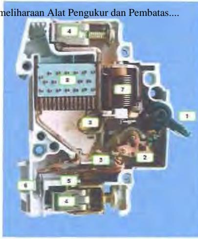
Gambar 2.9. bagian-bagian dalam MCB
