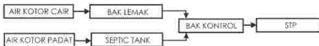
Skema 5.3. Sistem Air Kotor (Sumber: analisa pribadi)
