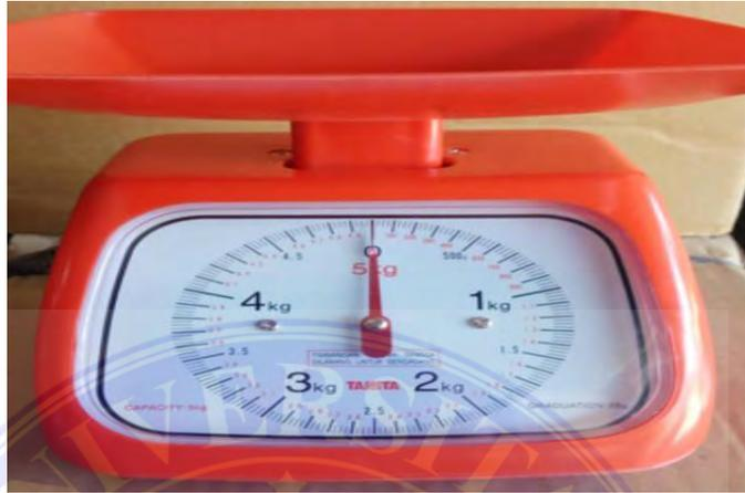
Gambar 3.5 Timbangan untuk menimbang berat bahan yang akan diuji sebagai bahan penyusun dari batako meliputi pasir dan plastik.
