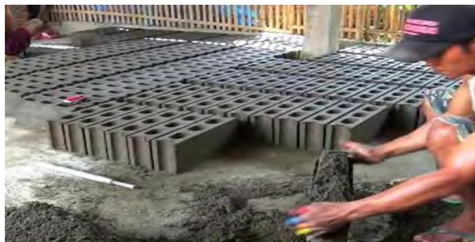
Gambar 2.5 Penyusunan Batako Yang Telah siap
