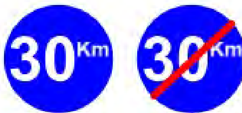
Gambar 5 Rambu perintah Sumber: Panduan fasilitas perlengkapan jalan
