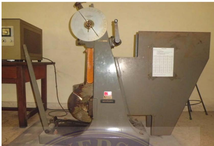
Gambar 3.1 Alat uji impak Charpy standar.
