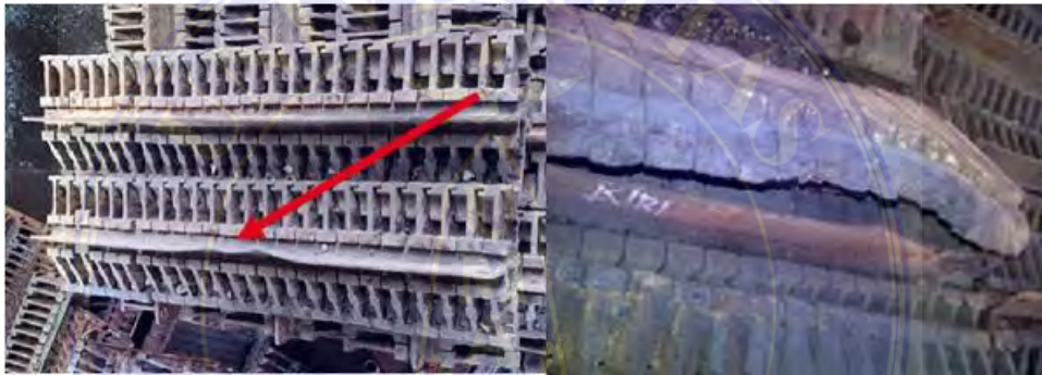
Gambar 1.3. Komponen traveling grate yang rusak
