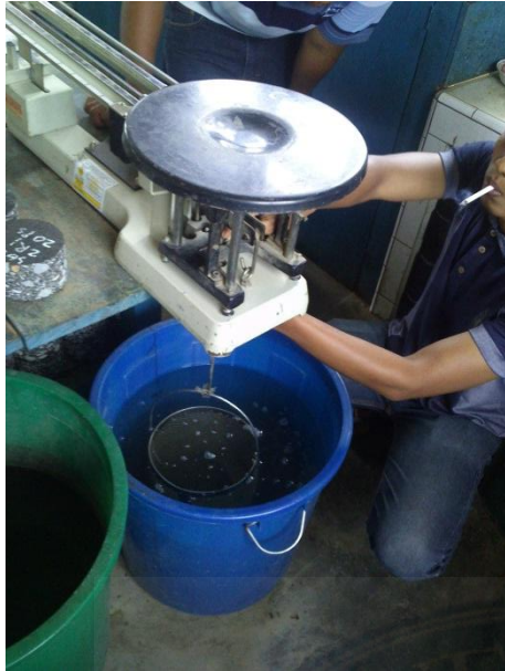
Mencari SPGR Agregat Kasar dengan menimbang agregat dalam air
