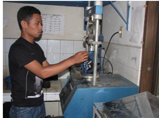
Pembuatan Benda Uji dan menguji Marhall Test
