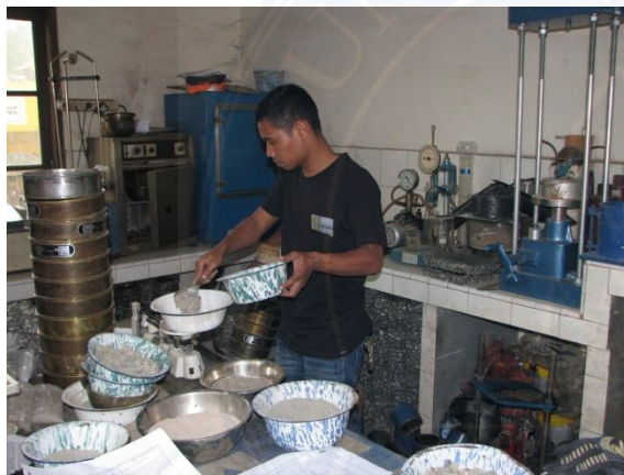
Mencari SPGR Agregat Kasar dengan menimbang agregat dalam air
