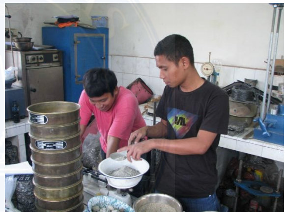
Mencari SPGR Agregat Kasar dengan menimbang agregat dalam air
