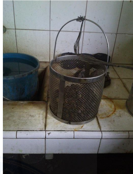
Mencari SPGR Agregat Kasar dengan menimbang agregat dalam air
