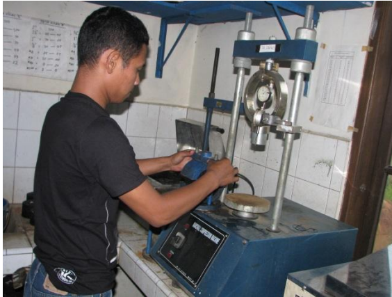
Pembuatan Benda Uji dan menguji Marhall Test
