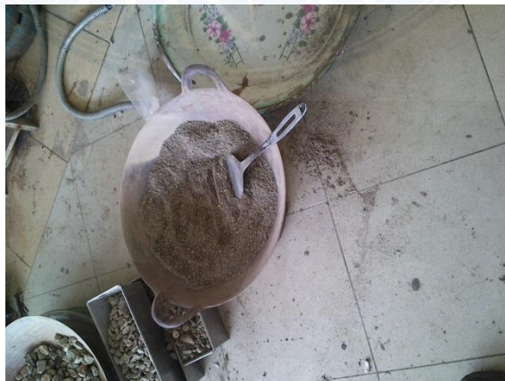
Mengeringkan agregat dengan kompor gas
