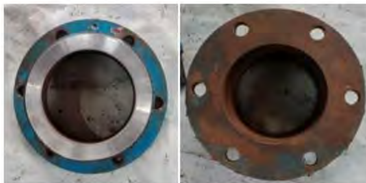
Gambar 3.1 Penutup Casing Screw Pellet Luar Dan Dalam Ekstruder Pellet
