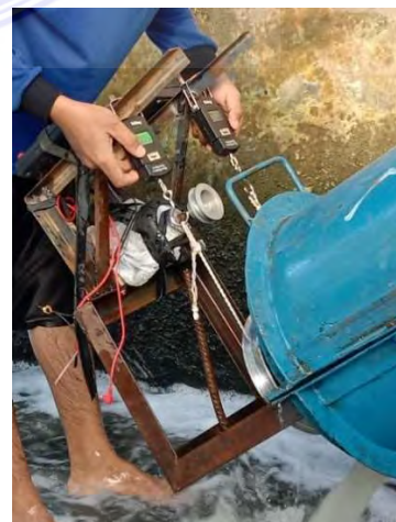
Gambar 3.17 Pengecekan Torsi dengan 2 timbangan
