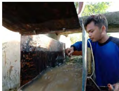
Gambar 3.10 Pengukuran Tinggi air menggunakan alat ukur mistar
