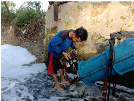
Gambar 3.17 Pengecekan Torsi dengan 2 timbangan
