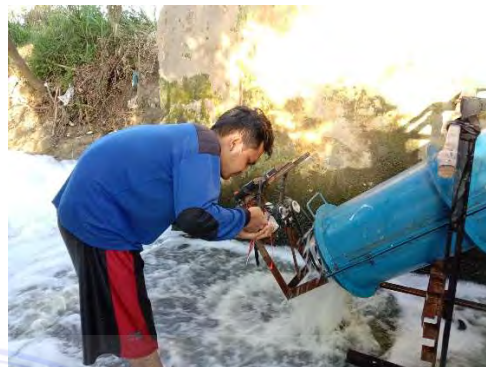
Gambar 3.13 Pengukuran Putaran Turbin Ulir
