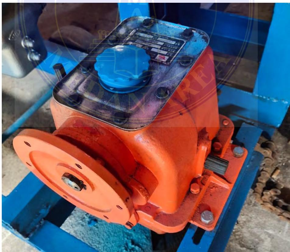
Gambar 3.3. Gear box reduser dari mesin penggerak ke screw.
