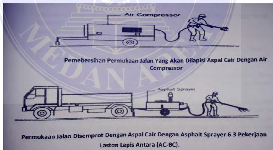
Gambar 2.6 Pekerjaan Lapis Resap Pengikat
