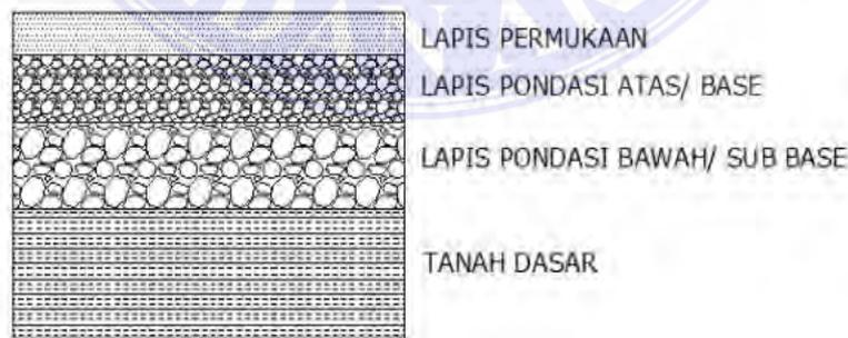
Gambar 2.1 Lapis Material Konstruksi Jalan
