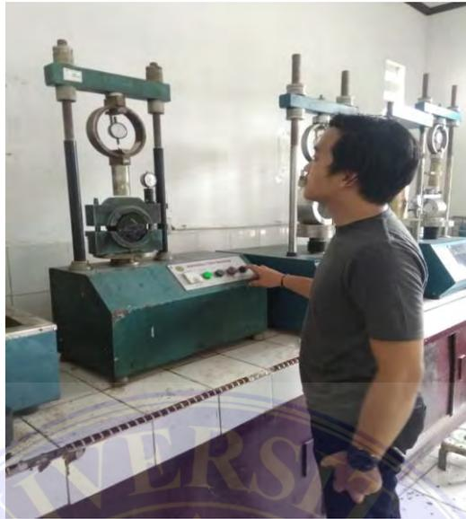
Gambar 3.9 Pengujian Marshall Test
