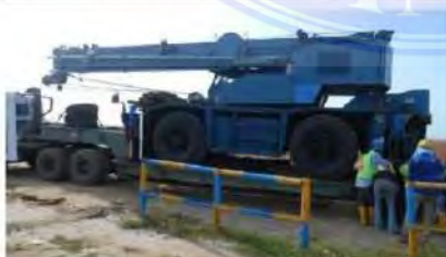
Gambar 3.3 Mobilisasi Crane 25 Ton
