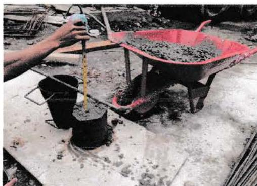
Gambar 4.6 uji slump
