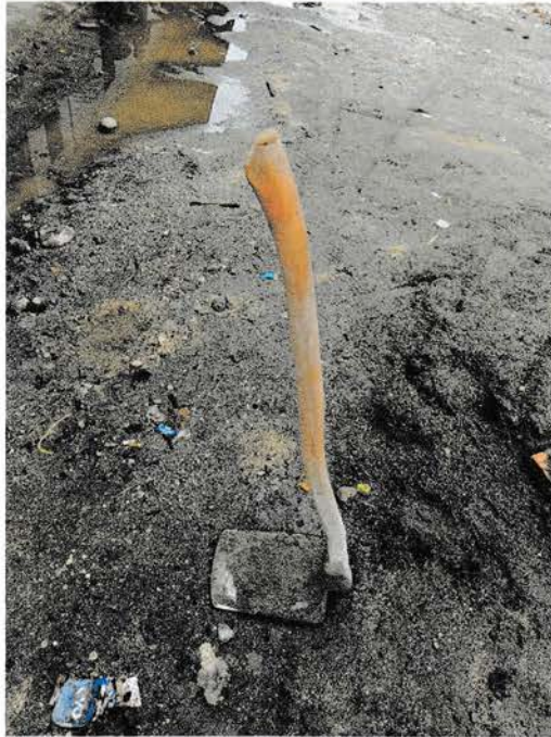
Gambar 4.35 Cangkul Sumber : Lokasi proyek
