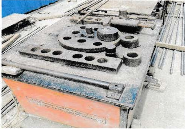
Gambar 4.23 Bar bender Sumber : Lokasi proyek
