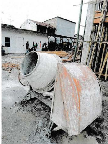
Gambar 4.29 Mixer Sumber : Lokasi proyek
