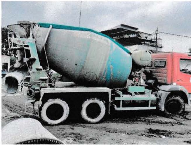
Gambar 4.27 Concrete mixer Sumber : Lokasi proyek
