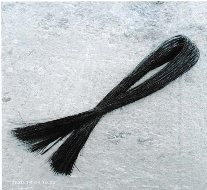
Gambar 4.12 Kawat beton Sumber : Lokasi proyek
