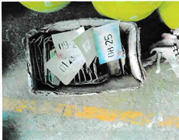
**Gambar 3.20 Alat Membuat Marka**
