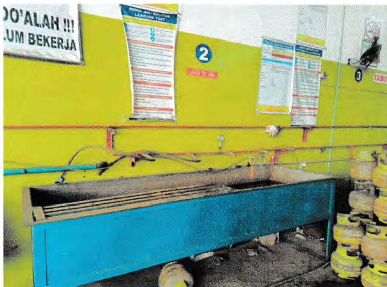
**Gambar 3.7 Bak Air dan Instalasi Angin**
