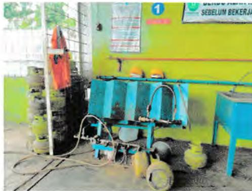
**Gambar 3.6** Alat untuk *Purging Gas Evaluation Pump*,
