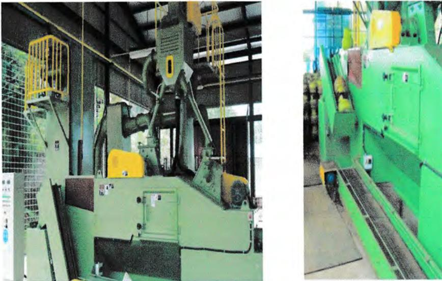
**Gambar 3.27** Mesin *Sandblasting*
