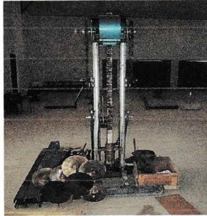
**Gambar IV.1 Mesin Sondir**
