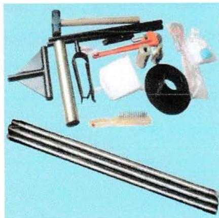
**Gambar IV.3 Perlengkapan Sondir**
