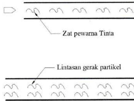
3. Aliran Transisi, Yaitu kondisi aliran peralihan dari aliran laminar menjadi aliran turbulen, atau dari turbulen menjadi laminar.
