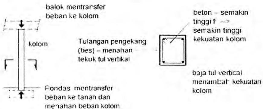
Gambar 2.1 Ilustrasi fungsi kolom
