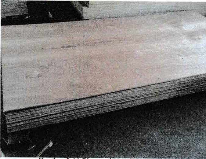
Gambar 2.11 Plywood Untuk Bekisting
