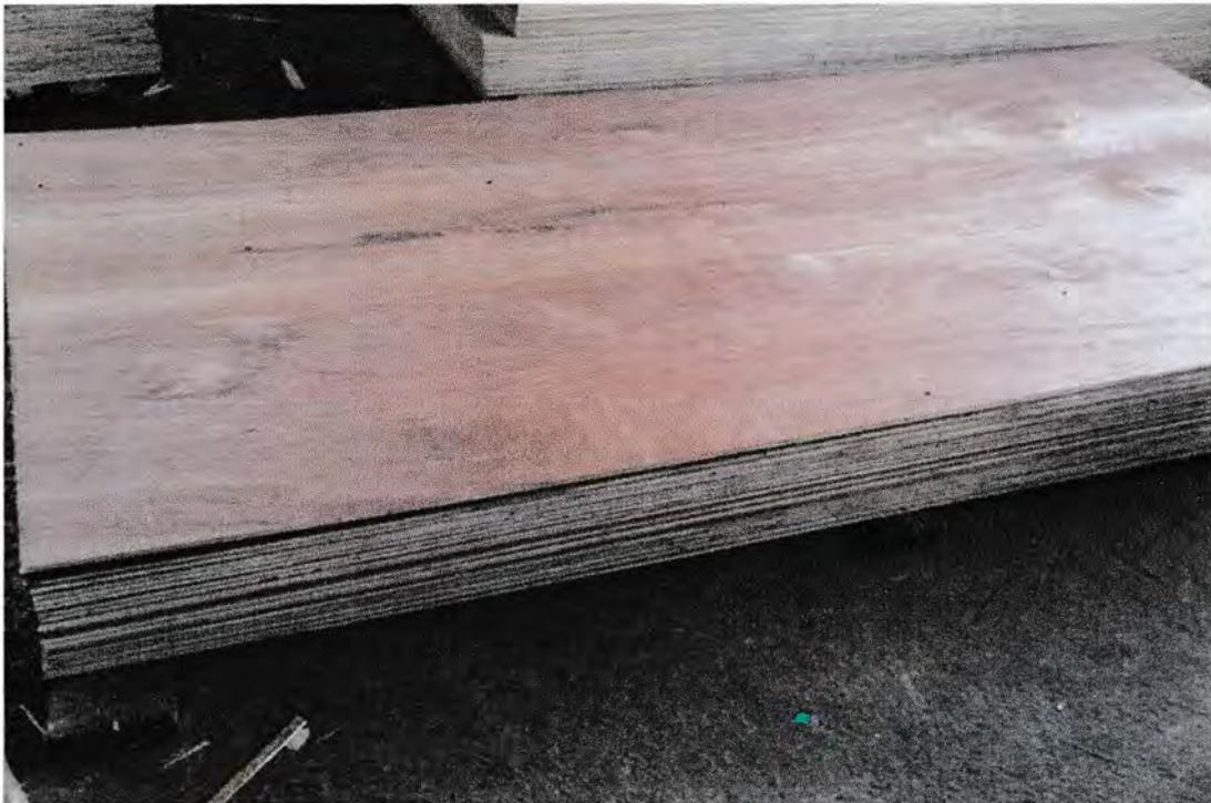
Gambar 2.11 Plywood Untuk Bekisting
