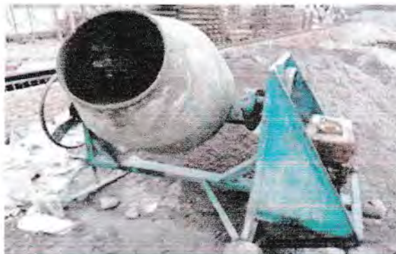
Gambar 3.8 Mixer Beton Mini
