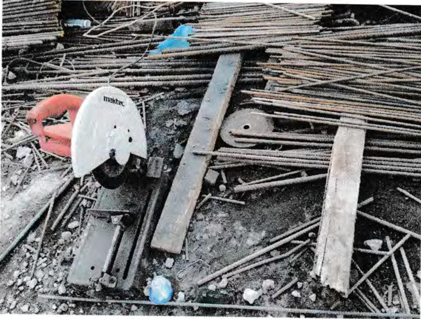
Gambar : Mesin Pemotong Besi Tulangan
