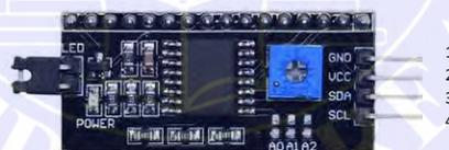
**Gambar 2.6 Komunikasi 4 Kabel IIC**
