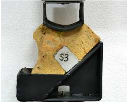
Gambar 7. Susunan test rig dan spesimen pada pengujian impact jatuh bebas
