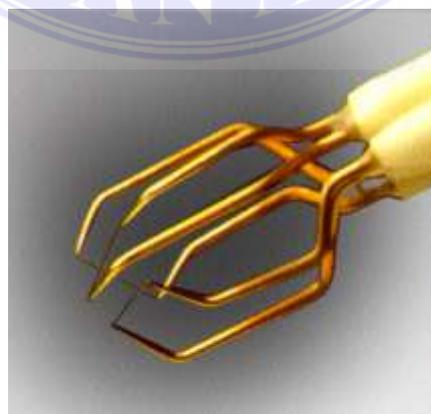
**Gambar 2.10. Probe Hot Wire**
