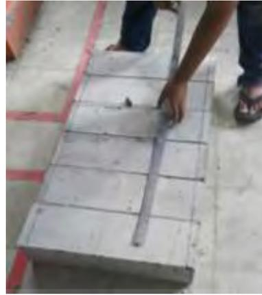
Gambar 3.4 benda uji berupa balok ukuran (15 x 15 x 50) cm
