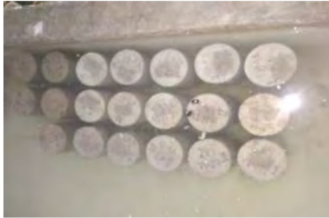
Gambar 10 Perendaman benda uji
