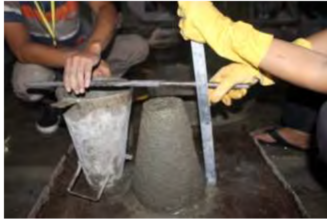
Gambar 07 Pengujian slump test
