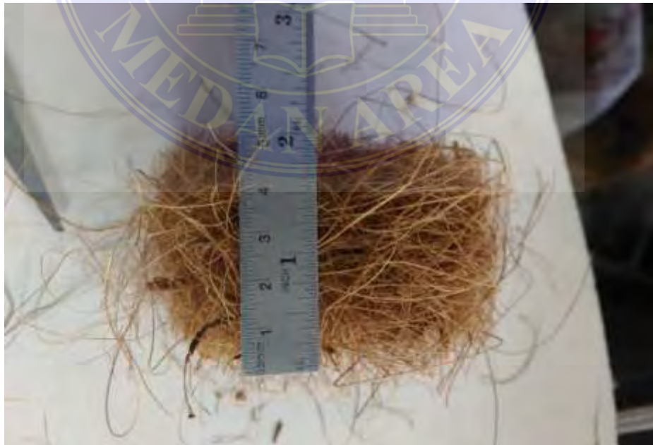
Gambar 3.11 Panjang ukuran sabut kelapa
