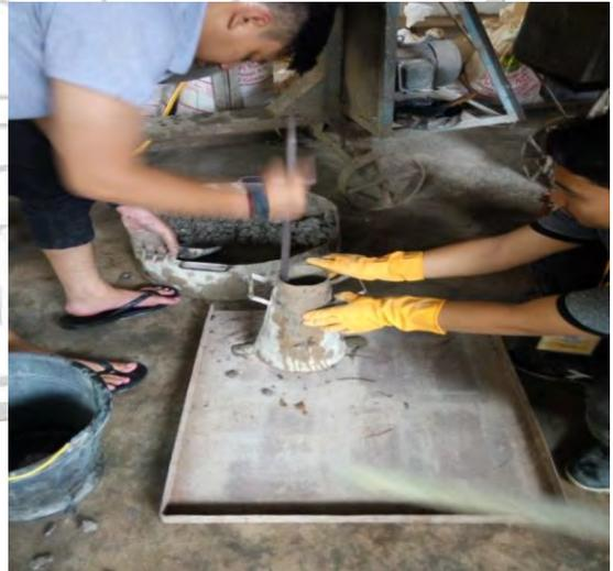
Memasukkan hasil pengecoran ke dalam kerucut dan sambil di rojok
