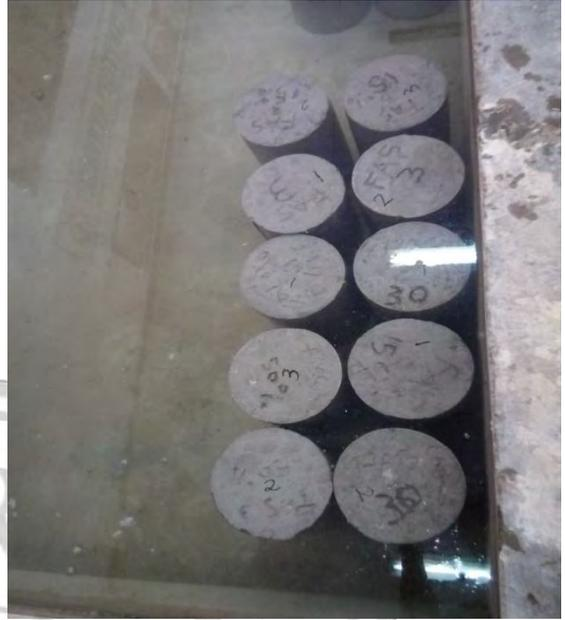
Silinder beton diletakkan ke dalam perendaman
