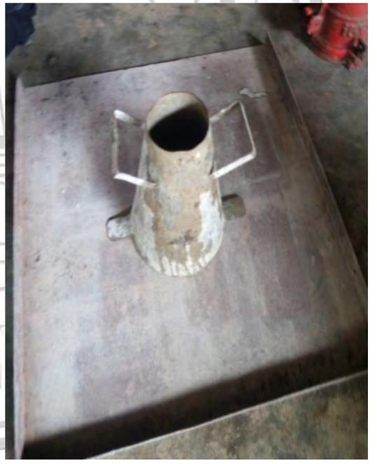
Kerucut untuk uji slump
