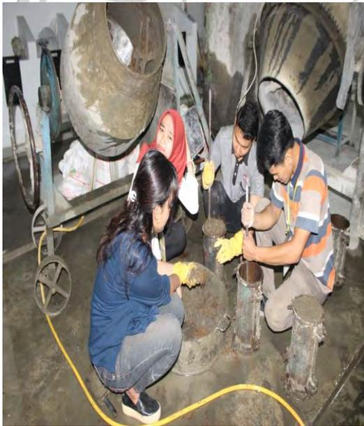
Memasukkan beton ke dalam cetakan silinder
