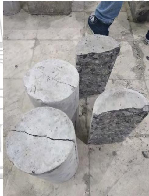
Pola retak yang diakibatkan saat pengujian kuat tarik belah beton
