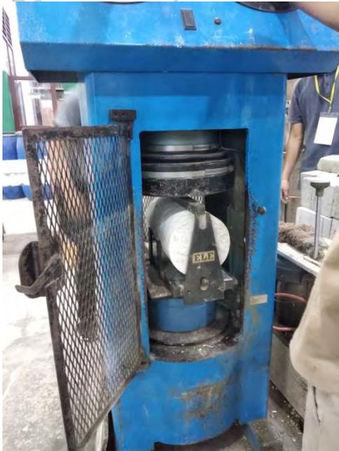
Proses pengujian benda uji silinder
