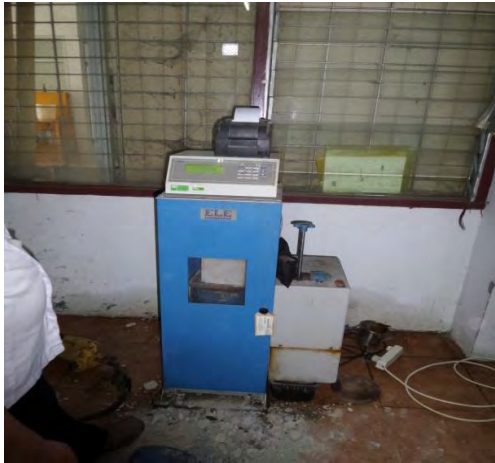
Gambar 14 Proses Uji Kuat tekan
