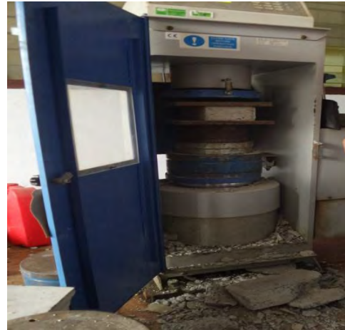
Gambar 21 Uji kuat tekan
